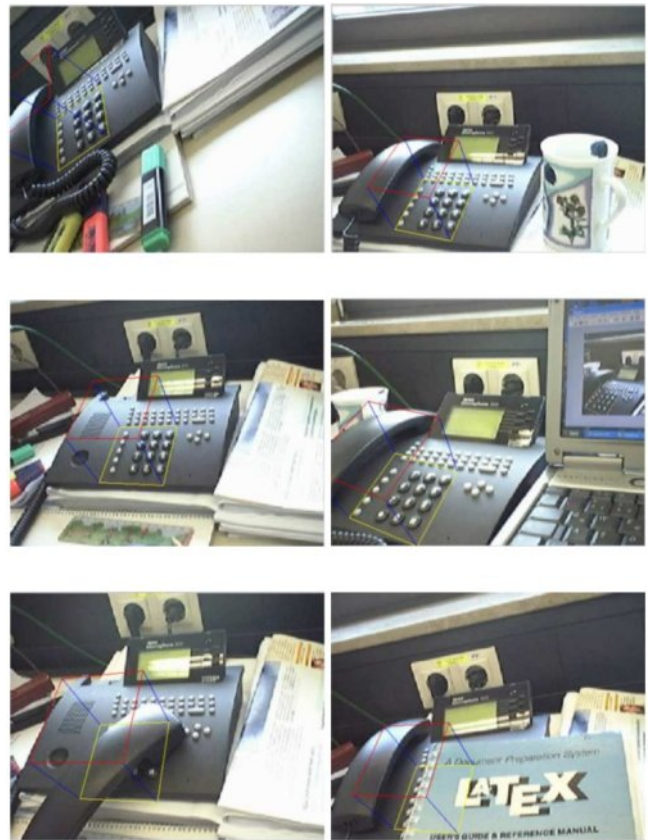
Abbildung 2: Einfaches Augmented Reality Beispiel mit Tracking. Die Wähltastatur wird vom virtuellen Quadrat eingerahmt, auf das zur Demonstration ein virtueller Kubus gesetzt wurde. Quelle: [Yuan 2006]
